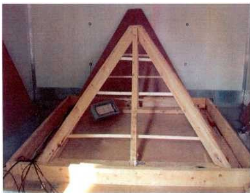
Фиг. 1 Покривна конструкция върху полистиролова основа
